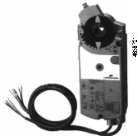
Elektrické rotační servopohony, jmenovitý krouticí moment 20 Nm, napájecí napětí 24V~, spojité regulační signál 0...10V=, zpětnovazební výstupní signál pro indikaci polohy 0...10V=, pracovní rozsah mechanicky nastavitelný mezi 0...90°, zapojené připojovací kabely o délce 0,9 m.
